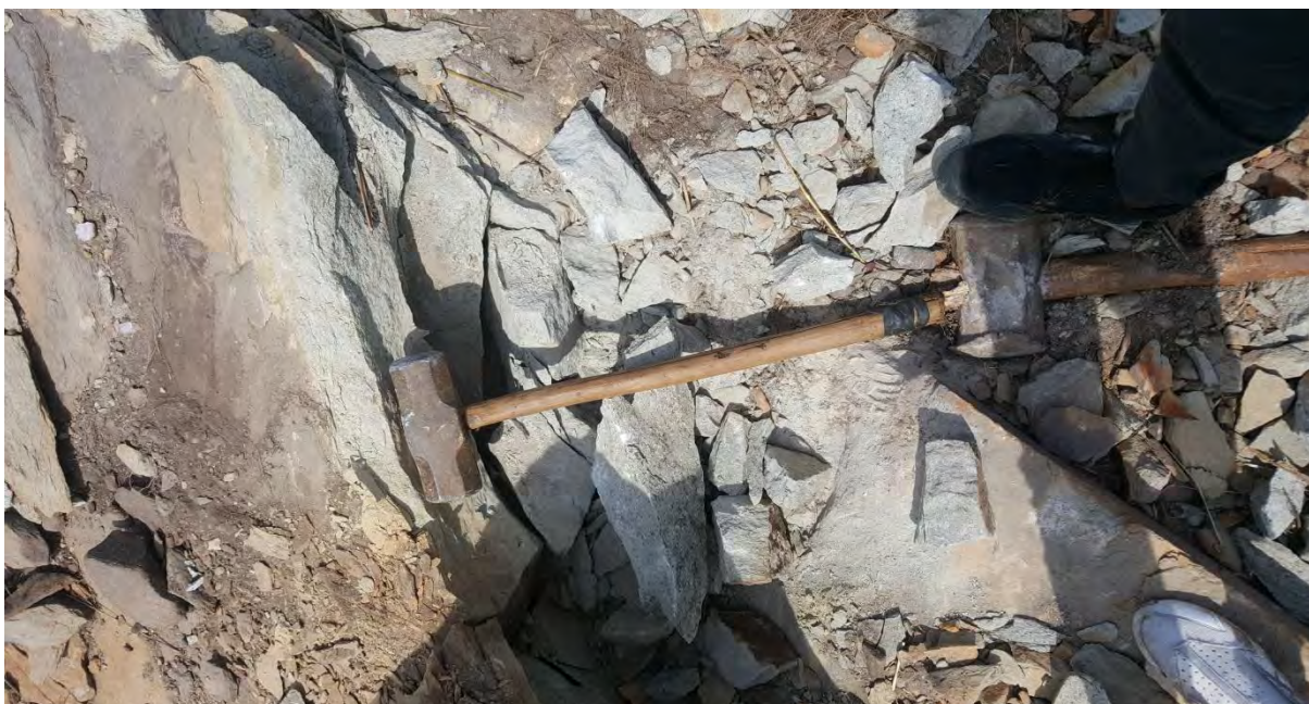
Figure 4: Description macroscopique : une roche métamorphique se débitant en plaquette, de couleur blanchâtre riche en quartz
